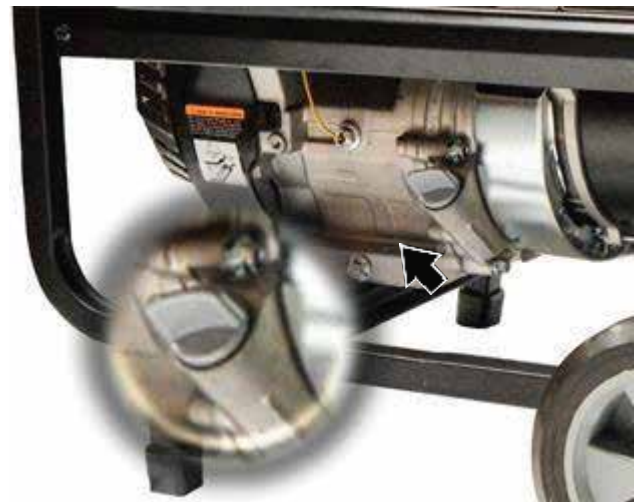
Figura 26 – Tapón de llenado/varilla de medición del aceite
