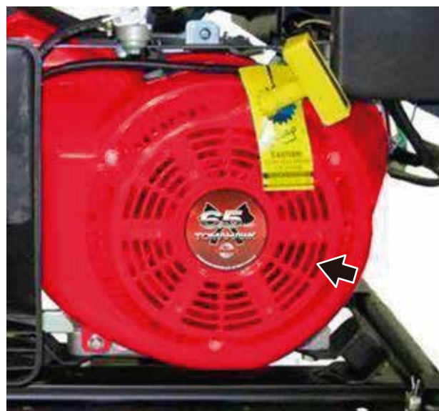
Figura 43 – Orificios de entrada y salida de aire del motor
