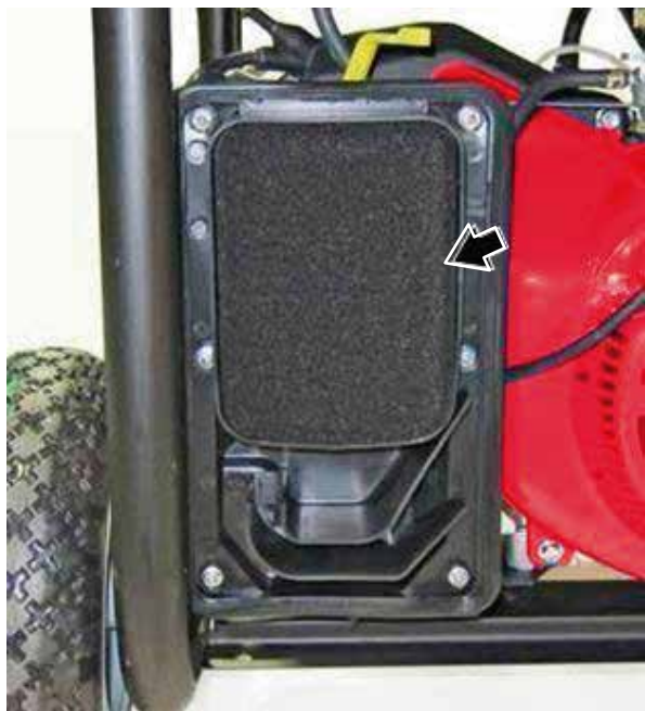
Figura 31 – Remoción del Elemento Áspero del Filtro de Aire
